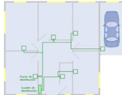
4.- Conexionado mezclando las tres topologías
