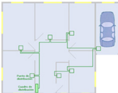
3.- Conexionado en bus continuo
